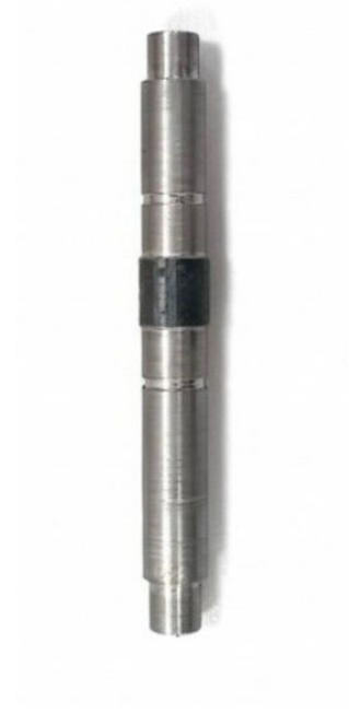
FIGURE 47 – Arbre de guidage en rotation fabriqué
