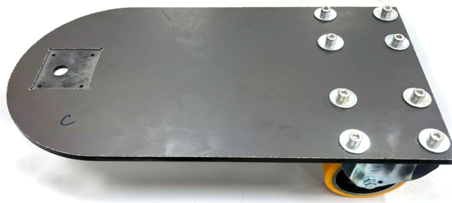
FIGURE 37 – Châssis réel de la plateforme mobile (avec roues arrières montées)
